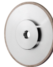
Diamant-Schleifscheibe für Hartmetall Zum Freischleifen von Werkzeugschäften Ø 110 x 12,75 x 5,0 mm Art. Nr. 58004
